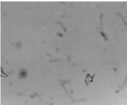
Figura 8 Flunisolide soluzione: osservazione al microscopio ottico: si osservano granuli sparsi di sali minerali di 15-30 µm di diametro. Foto effettuata dal Prof. Lorenzo Sottile.
